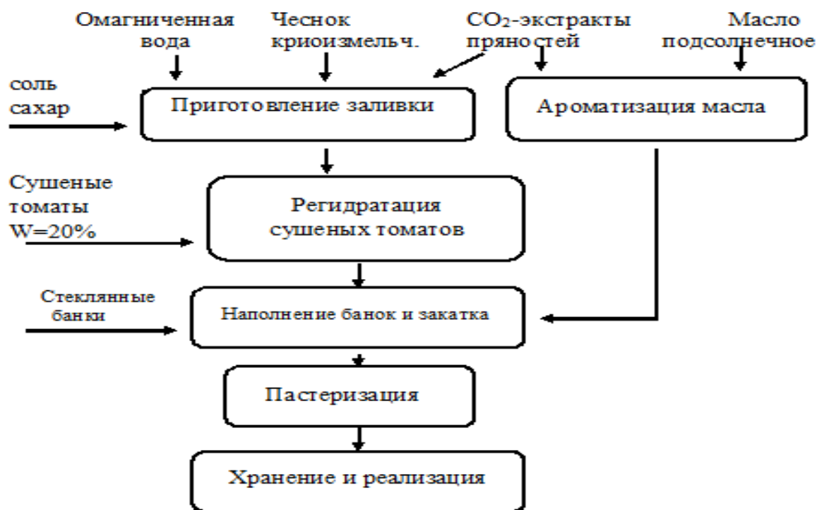
Рисунок 2 – Технологическая схема производства консервов «Сушёные томаты в масле с СО 2 -экстрактами пряностей»
