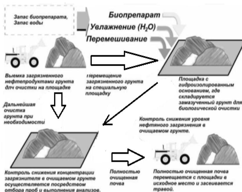
Рисунок – Схема очистки загрязнённого грунта
