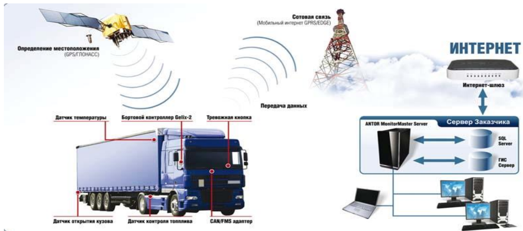
Рисунок 3.1 - Архитектура системы GPS/ГЛОНАСС мониторинга ANTOR MonitorMaster
