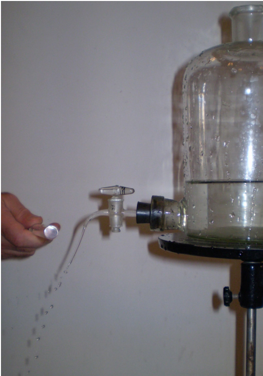
Св. 2 Відхилення струменя води у електричному полі.
