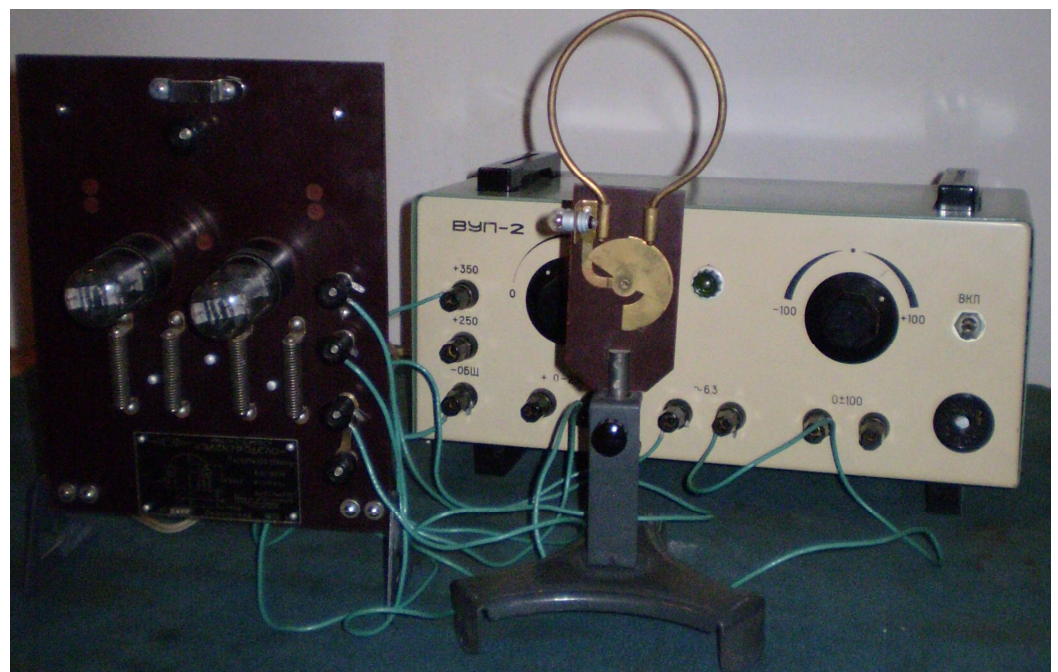
Св. 10 Обладнання для демонстрації резонансу коливальних контурів
