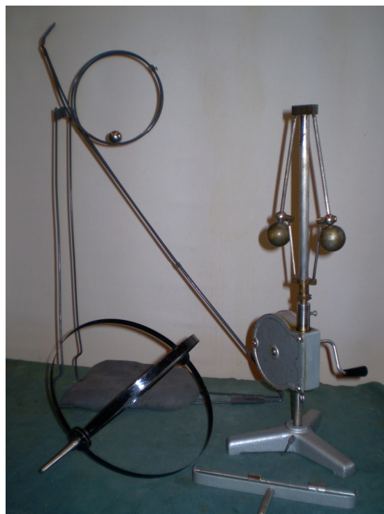
Св. 14. Прилади для демонстрації відцентрових сил.
