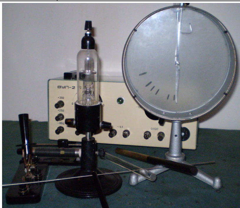
Св. 1. Обладнання для демонстрації явища термоелектронної емісії
