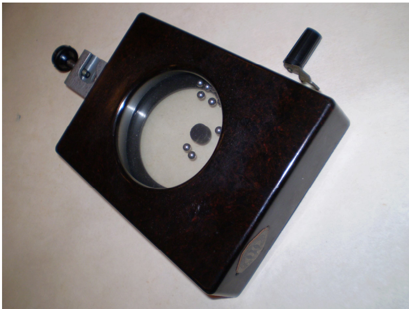
Св. 1. Механічна модель приладу для демонстрації Броунівського руху.
