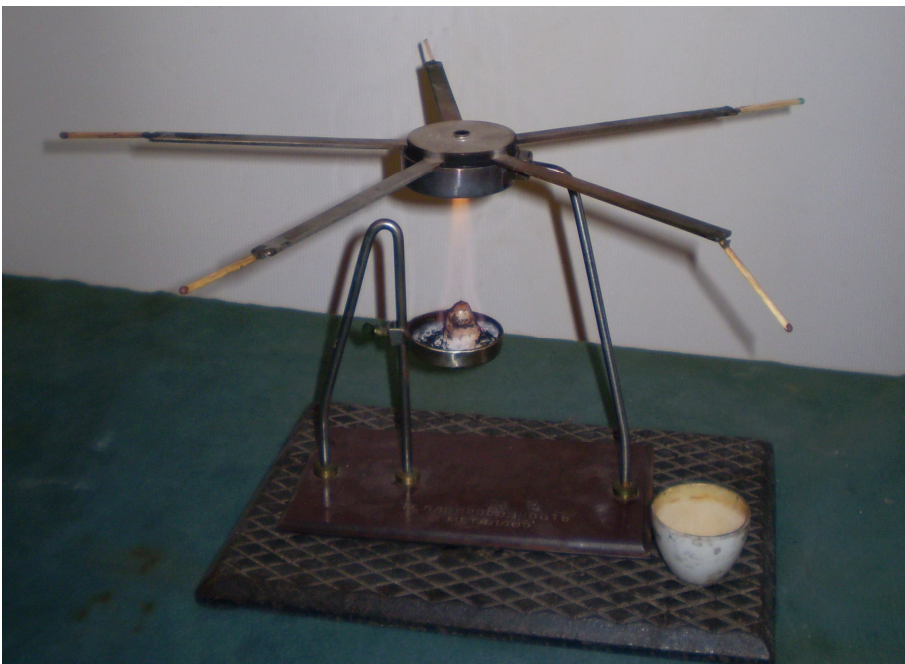
Св. 4. Демонстрація ефекту різної теплопровідності металів.
