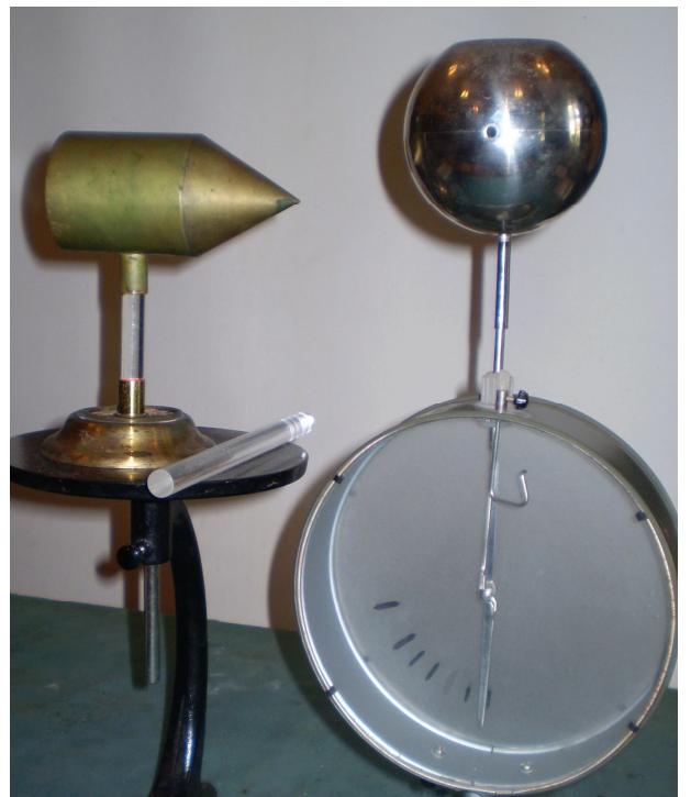
Св. 5. Обладнання для аналізу розподілу зарядів по поверхні
