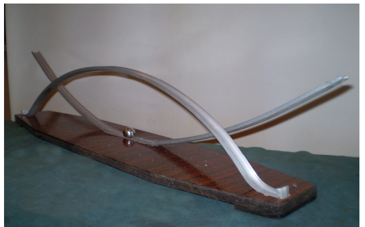
Св. 10(а,б). Демонстрації видів рівноваги а) ширяння орла, б) вгнуті та вигнуті доріжки
