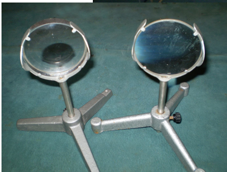
Св.2. Обладнання для демонстрації явища заломлення світла у воді та порожнистих лінзах
