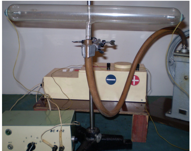
Св. 10. Демонстрація електричного струму у трубці із розрідженим повітрям
