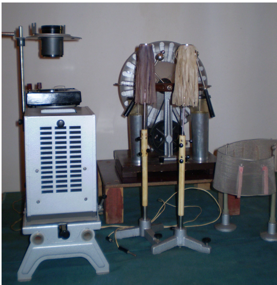
Св. 11. Обладнання для демонстрації силових ліній електричного поля.
