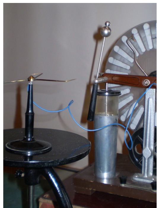
Св. 7. «Електричний вітер» штовхає колесо Франкліна.
