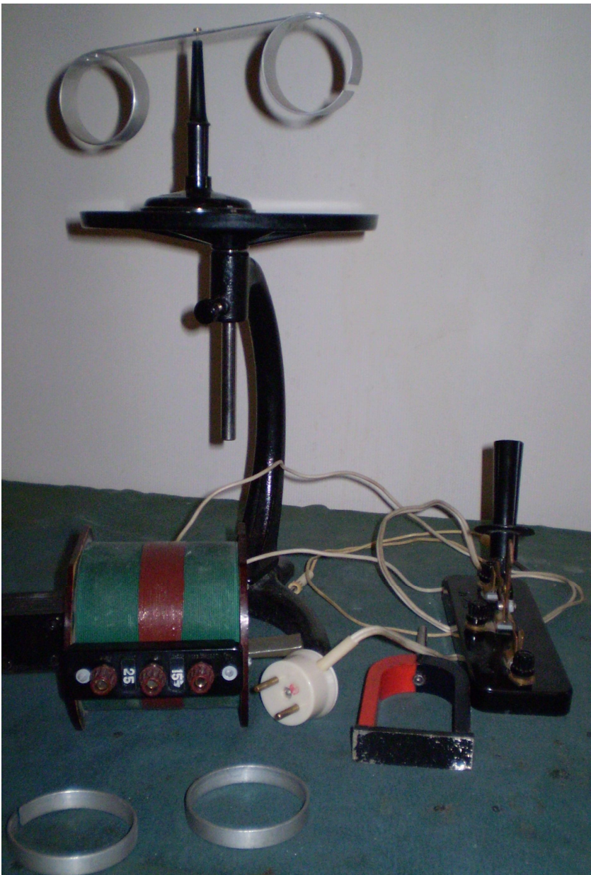
Св.2 Обладнання для демонстрації наслідків дії правила Ленца.
