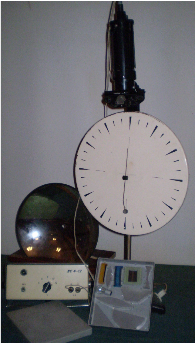
Св. 1. Оптична шайба, прилад з геометричної оптики та вгнуте дзеркало
