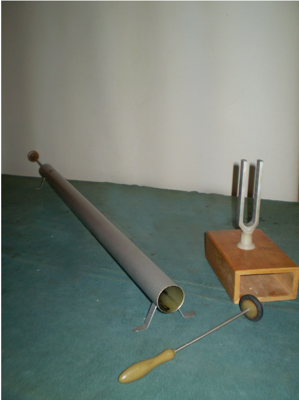
Св. 7 Обладнання для вимірювання швидкості звука у повітрі.
