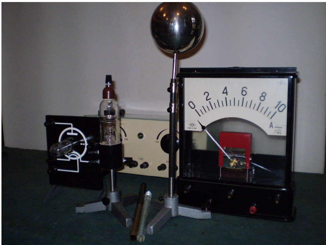
Св.2. Обладнання для демонстрації принципу дії трьохелектродної електронної лампи.
