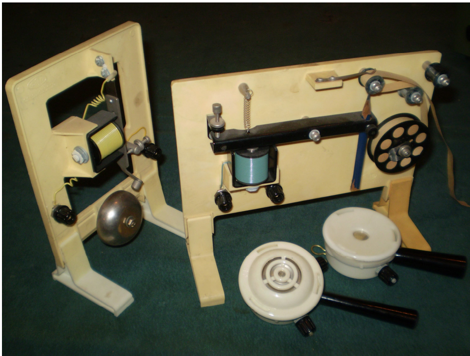
Св. 11. Моделі приладів, у яких використовується магнітна дія електричного струму.
