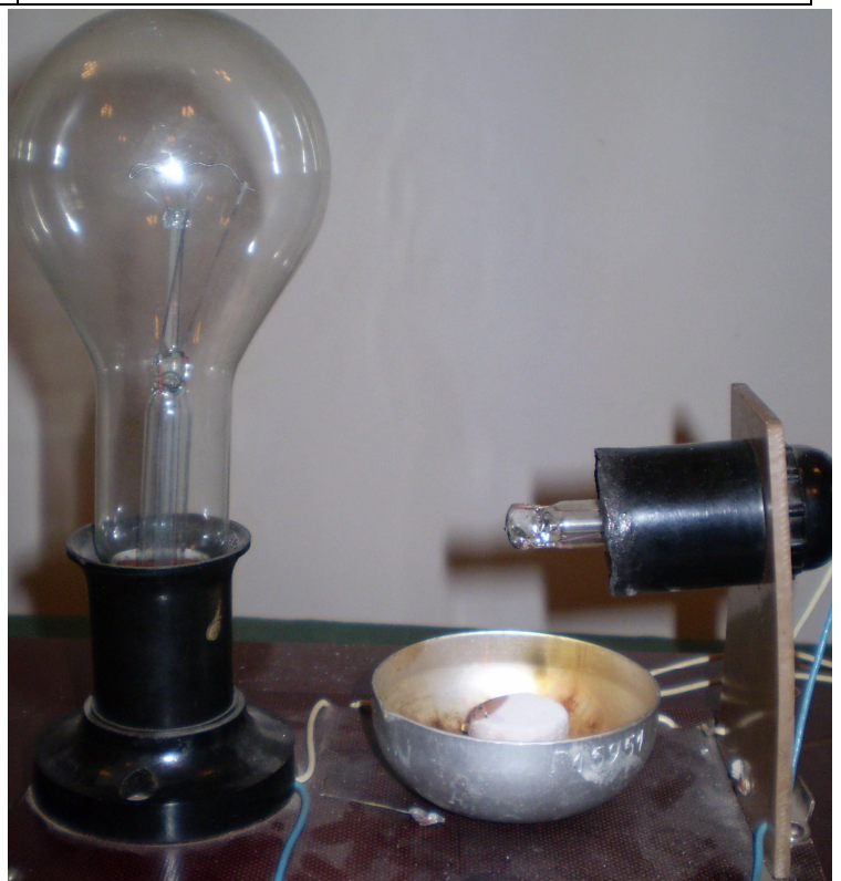
Св. 5 Демонстрація залежності провідності скла від температури
