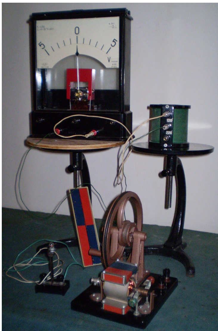
Св. 1. Обладнання для демонстрації явища електромагнітної індукції
