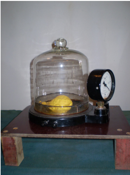
Св. 2. Роздування гумової кульки при пониженому тиску навколо.
