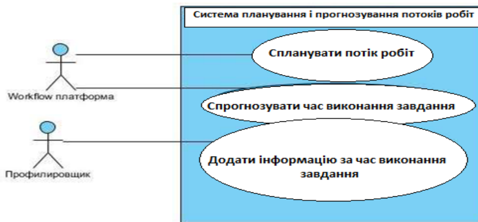
Рис. 1. Діаграма варіантів використання системи планування й прогнозування потоків робіт
