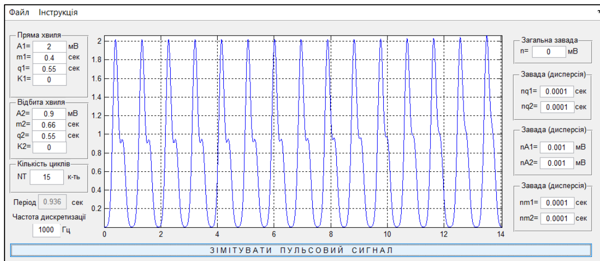
Рис. 1. Комп'ютерний генератор тестових сигналів пульсової хвилі судин людини
