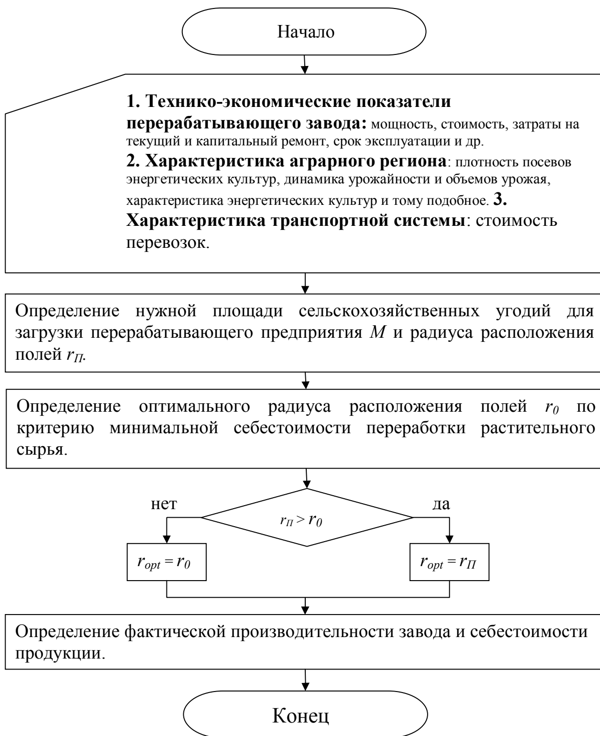
Рис. 6.6. Блок-схема алгоритма определения основных показателей завода по производству биотоплива
