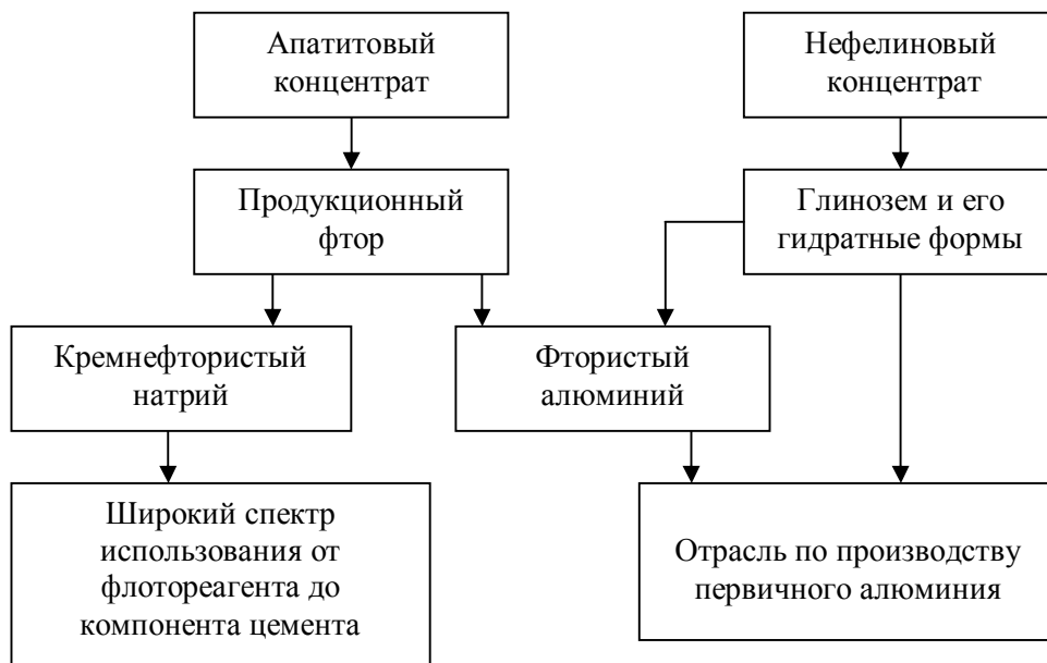
Рис. 9.1. Схема переработки апатитового и нефелинового концентрата
