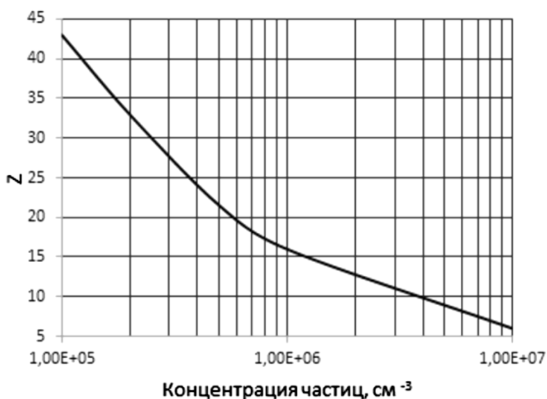
Рис. 2. Зависимость заряда (в элементарных зарядах) частицы ТССА диаметром 0.24 мкм от концентрации частиц в ГВС: I_k = 400 мкм, U_k = +5.8 кВ, Q = 18 м 3 /час.
