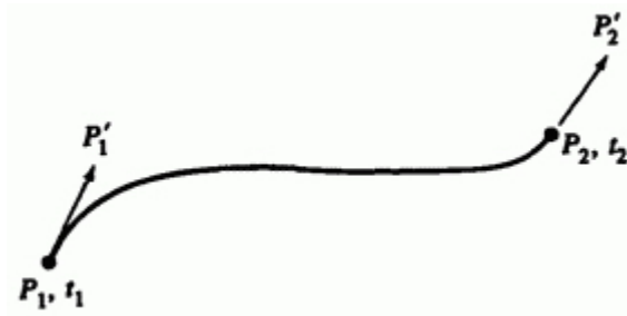
Рис. 5. Один сегмент кубического сплайна.
