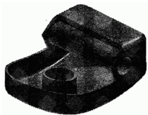
Рис. 10.4. Тонкостенное тело, построенное внутрь от базового тела
