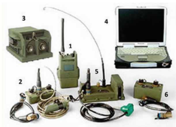
Рис. 3. Основні елементи системи «REMBASS-II» [9]: 1 - засіб індексації та програмування AN/PRQ-16 (для прийому даних від РСЗ); 2 - інфрачервоний РСЗ МК-2965/GRS; 3 - радіоретранслятор; 4 - станція обробки (польовий комп'ютер); 5 - сейсмоакустичний РСЗ МК-2967/GRS; 6 - магнітний РСЗ МК-2966/GRS
