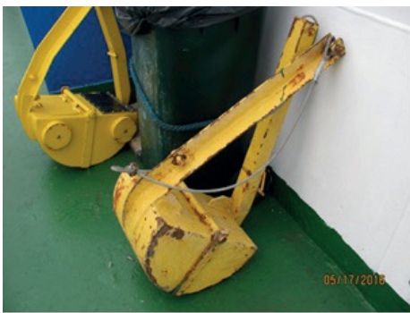
Рис. 4. Устаткування для відбору проб (дночерпак) та процес пробовідбору
