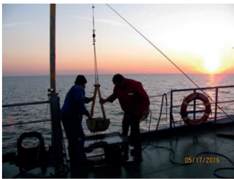
Рис. 4. Устаткування для відбору проб (дночерпак) та процес пробовідбору
