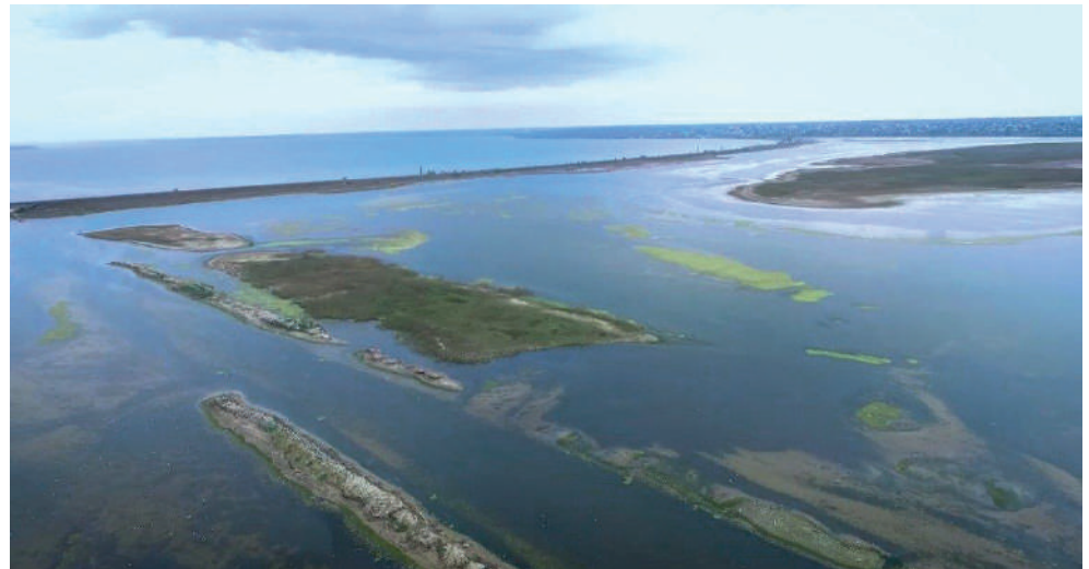
Рис. 7. Приклад затоплення поверхні пересипу Тилігульського лиману морськими водами під час сильного шторму (швидкість південного вітру сягала 23 м/с). Стікання вод затоплення багато у чому забезпечується каналом (у лівому нижньому куті фото)
