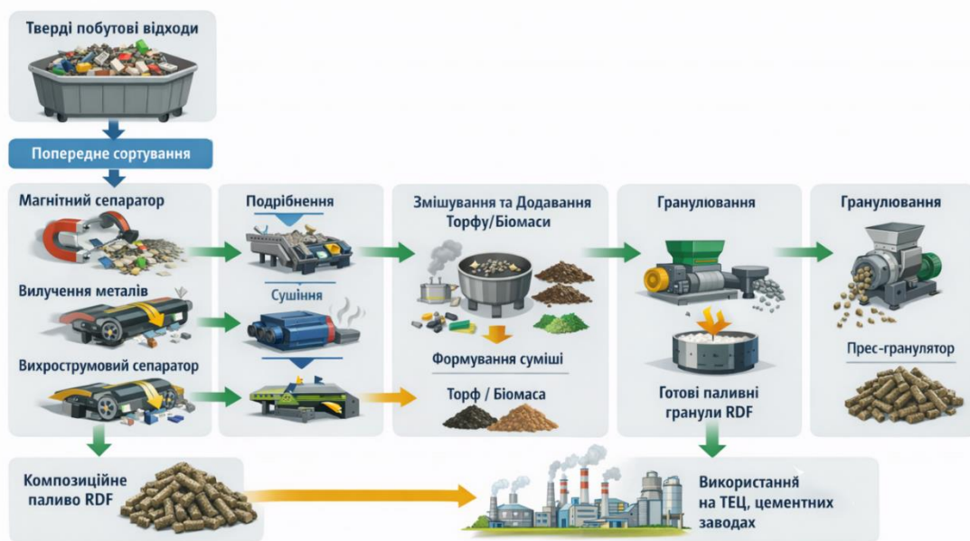
Рисунок 1 – Технологічна схема перероблення побутових відходів
