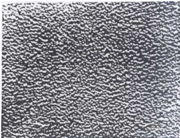
Рис. 4. Структура приповерхнього шару п'єзокераміки ЦТС-42 (збільшення \times 400 , дозвольна здатність 0,7 мкм, поле зору 400 мкм).
