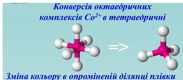
Рис. 4. Фотохромно-чутливий до випромінювання у середній та далекій інфрачервоній областях спектра (більше 4 мкм) плівковий композитний матеріал.
