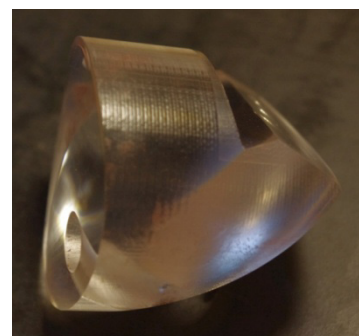
Рис. 4. Приймальний ОВК з оригінальним оптичним елементом/1 – дзеркальний оптичний елемент циліндричної форми, 2 – торопараболічне увігнуто дзеркало, 3 – плоске дзеркало, 4 – вхідний кінець приймального ОВК, 5 – промінь відбитого від поверхні об'єкта випромінювання
