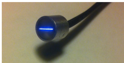
Рис. 5. Фото дослідного зразка передавального ОВК
