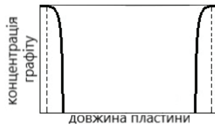
Рис. 7. Розподілення наночастинок графіту у сформованому ансамблі.
