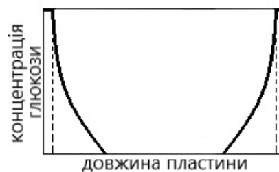
Рис. 6. Розподілення глюкози всередині пластини шпаристого скла.
