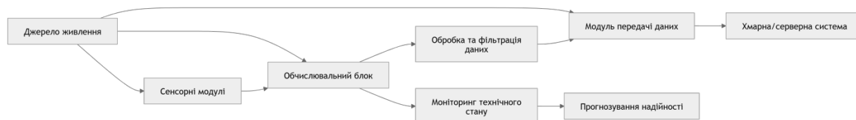
Рис. 1. Архітектура програмно-апаратного комплексу мобільної сенсорної системи.
