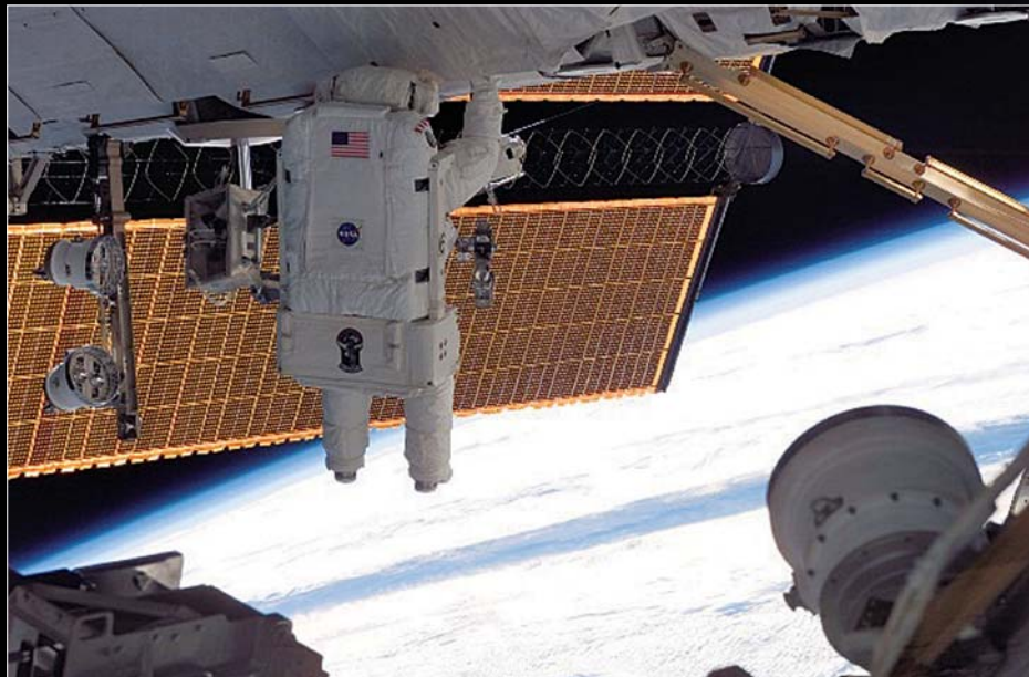
Стивен Свонсон и Патрик Форрестер (последний на снимке не виден) во время второго запланированного выхода в космос выполняют монтажные работы по креплению секций солнечных батарей (13 июня).
