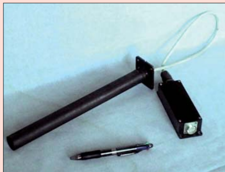
Волновой зонд, не имеющий аналогов в мире: одновременно измеряет три параметра ионосферы, масса прибора 350 г
