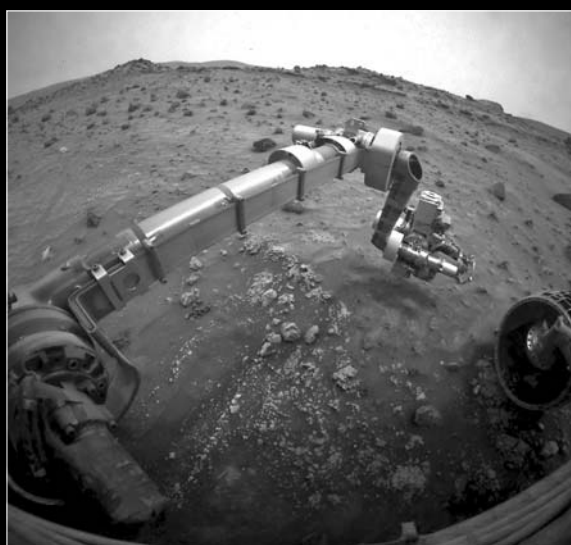
Spirit осуществил движение своим манипулятором для перемещения камеры микроскопа в свой 1277 сол (6 августа), впервые за двадцать дней.
