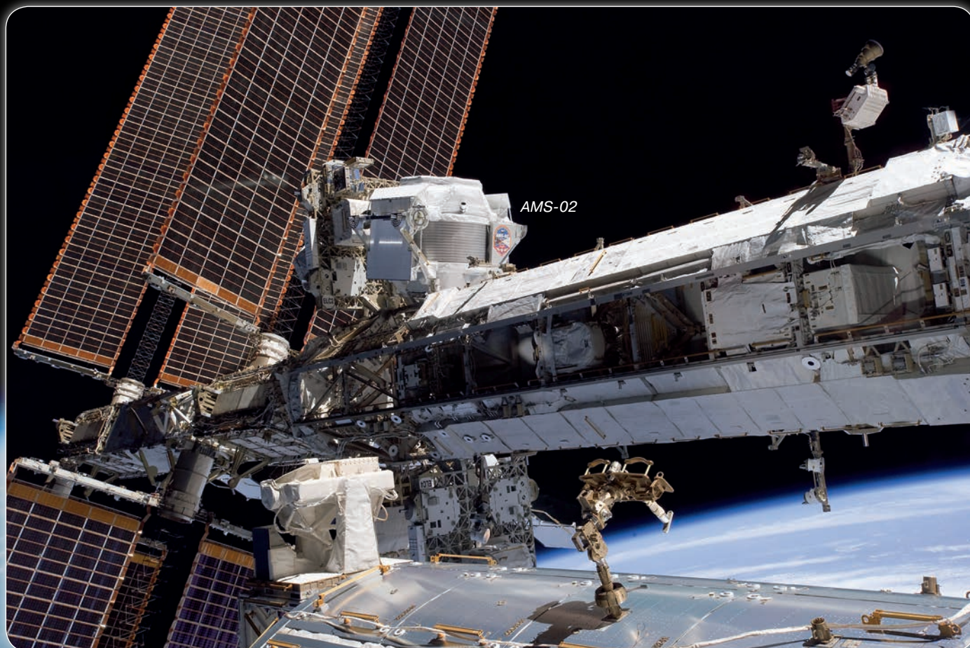
AMS-02 был установлен на сегменте S3 правой ветви ферменной конструкции МКС.
