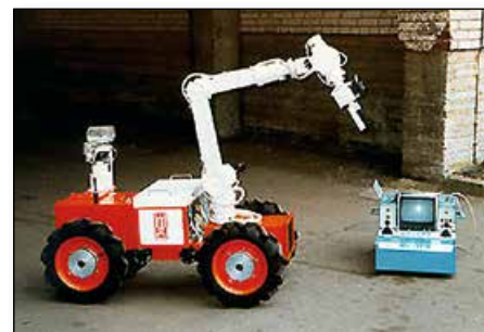
Радиоуправляемый робот-разведчик (справа — пульт управления) для поиска радиоактивных объектов, оборудованный гамма-локатором и манипулятором с детектором ионизирующего излучения и тремя телевизионными камерами.
