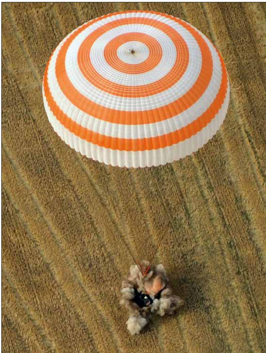
Мягкая посадка возвращаемой капсулы «Союза» обеспечивается системой «Кактус».
