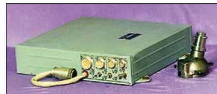
Система «Кактус»: передатчик (справа) и приемник.
