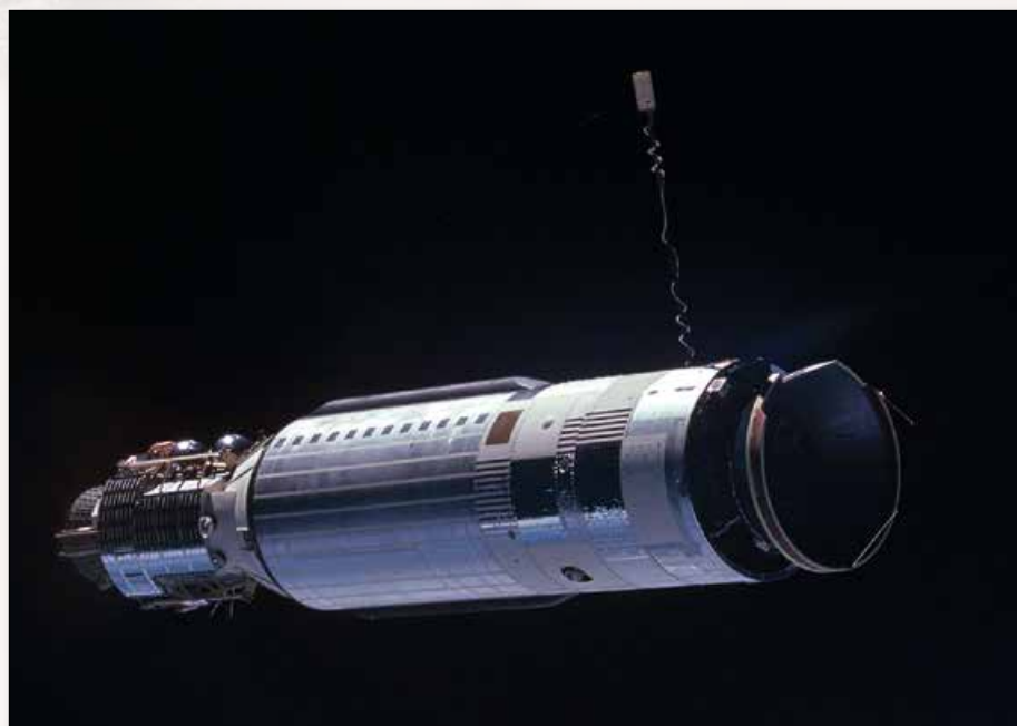
Орбитальный блок Agena, использовавшийся для отработки операций по стыковке в ходе миссии Gemini 8 в марте 1966 г.
