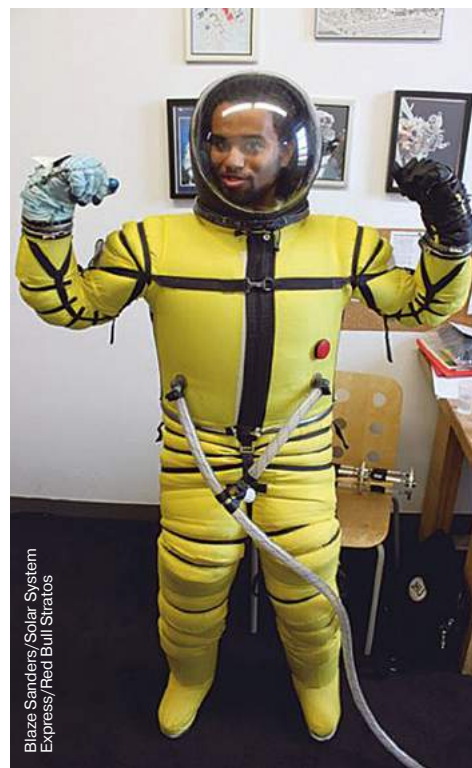
▲ Полноразмерный прототип «спасательного скафандра» разработки компаний Solar System Express и Juxtopia LLC.
