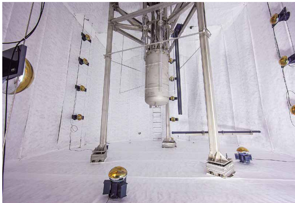
▲ Фотография детектора темной материи LUX, установленного в центре резервуара, который будет заполнен 265 кубометрами ультрачистой деионизированной воды. Эта вода должна защитить детектор от влияния фоновой радиации. Стены резервуара облицованы хорошо отражающей материей. Четыре колонны фотоэлектронных умножителей предназначены для регистрации слабых вспышек света, вызванных немногочисленными космическими лучами, проникшими на большую глубину. Впоследствии эти сигналы исключат из итоговых наблюдений.
