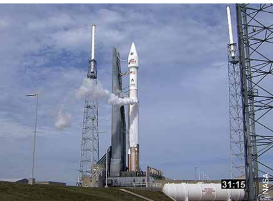
▲ Заправка первой ступени ракеты-носителя Atlas V жидким кислородом на стартовом комплексе №41 станции ВВС США «Мыс Канаверал». Через несколько часов с помощью этой ракеты будет запущен марсианский орбитальный зонд MAVEN.
