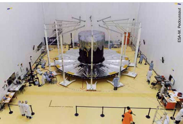
▲ Светоотражающий экран DSA (Deployable Sunshield Assembly) космического аппарата Gaia во время испытаний механизма разворачивания в сборочном ангаре S1B космодрома Куру (Французская Гвиана) 10 октября 2013 г.
