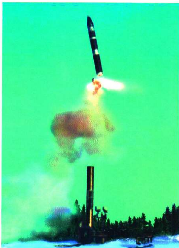
▲ Отличительной особенностью старта ракеты «Молодец» железнодорожного базирования стал принудительный заклон, выполнявшийся для снижения воздействия струи маршевого двигателя на ракетный поезд.
