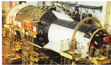
▲ Орбитальная пилотируемая станция «Алмаз» в сборочном цеху.
