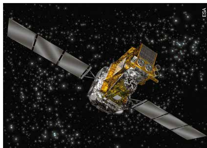
▲ Космическая гамма-обсерватория INTEGRAL (иллюстрация). В передней части — инструменты SPI с круговой и IBIS с квадратной кодирующей маской.
