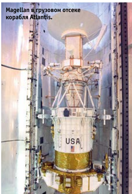
Выведение АМС Magellan с разгонным блоком IUS (Inertial Upper Stage) из грузового отсека шаттла.
