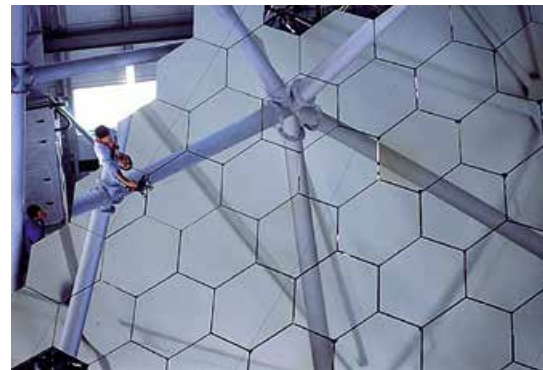
▲ Составное главное зеркало телескопа SALT.
