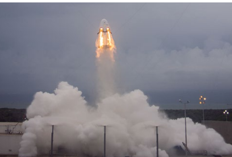
▲ Макет капсулы пилотируемой версии корабля Dragon компании SpaceX стартует с пусковой площадки космодрома на мысе Канаверал во время испытаний системы аварийного спасения 6 мая 2015 г. Его полет продолжался 99 секунд.
