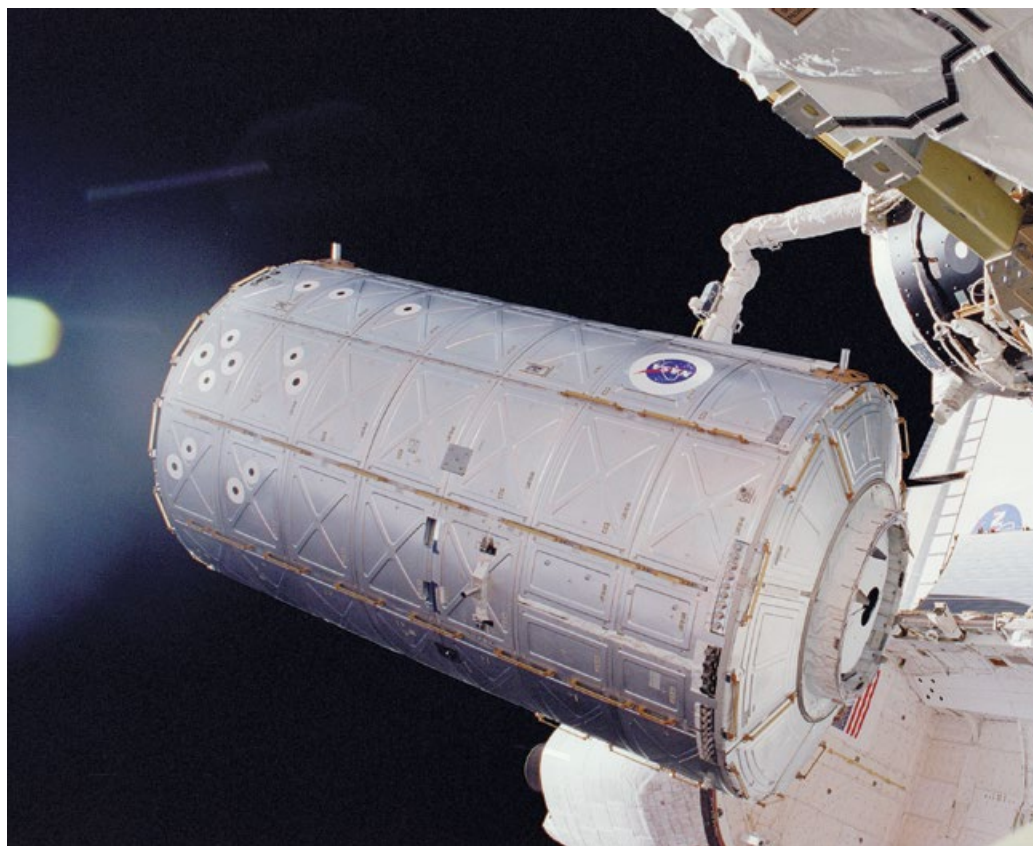
▼ Модуль Destiny поднят над отсеком полезной нагрузки шаттла перед пристыковкой к МКС.
