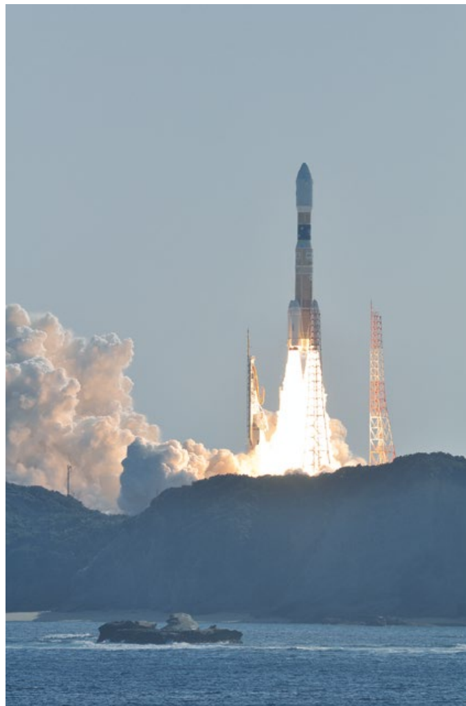
▲ Второй полет японского носителя H-IIВ, в ходе которого к Международной космической станции был отправлен беспилотный грузовой корабль HTV2 «Конотори». Ракета работает на жидком топливе и дополнительно оснащена твердотопливными ускорителями. Ее запуски производятся с космодрома Танегасима.
