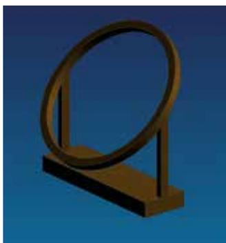
▲ Экваториальное кольцо — инструмент, использовавшийся Гиппархом для наблюдения равноденствий. Тень от кольца падает на сам прибор только тогда, когда Солнце находится на небесном экваторе (то есть в точках равноденствий). Таким образом, с помощью этого инструмента можно с довольно высокой точностью определять моменты равноденствий.
