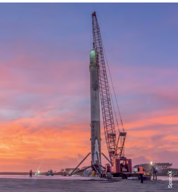
▲ Первая ступень ракеты Falcon 9 после возвращения на Землю в посадочной зоне LZ-1 на мысе Канаверал.
