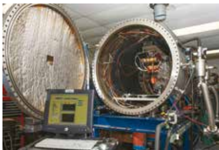
▲ Инженер Брюс Вигманн (Bruce Wiegmann), главный исследователь концепции HERTS E-Sail, демонстрирует провода, являющиеся составными элементами нового двигателя. Каждый провод имеет толщину всего 1 мм, а их длина в рабочем положении достигнет 20 км.
