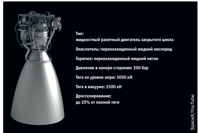
▲ Новый криогенный двигатель Raptor, по словам Маска, должен быть втрое мощнее двигателя Merlin, устанавливаемого в настоящее время на ракете Falcon 9
