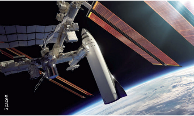
▲ Предполагается, что вторая ступень ракеты BFR сможет стыковаться с Международной космической станцией. На этом изображении, созданном с помощью компьютерной графики, хорошо виден ее относительный размер.
