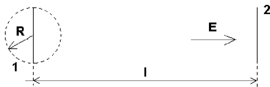
Рис. 3. Излучение источником на поверхность датчика. 1 — источник излучения; 2 — чувствительная поверхность датчика пирометра; l — расстояние от источника до поверхности датчика; R — радиус частицы.
