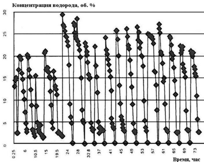
Рис. 9. Динамика выделения водорода при многоцикловых операциях
