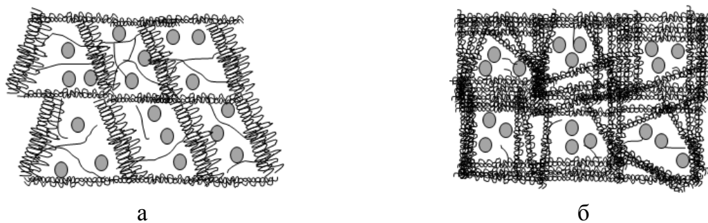
Рис. 5. Схема структури гідрогелю желатину, обробленого магнітним полем: а – рідка сітка (концентрація 5-15%) ; б- твердий розчин заміщення (концентрація 15-25%)
