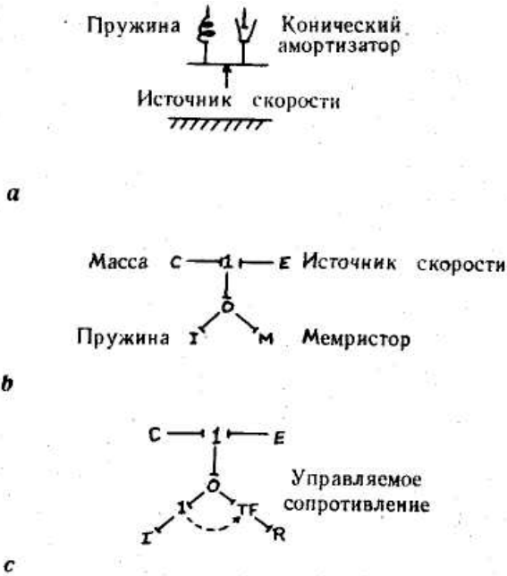
Рис.4. Схематическое изображение и граф связей для механической системы с управляемым смещением амортизатора.
