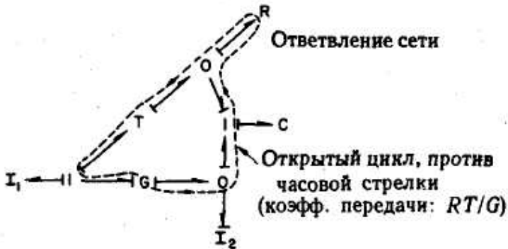
Рис.4. Пример открытого цикла, содержащего ответвление сети.
