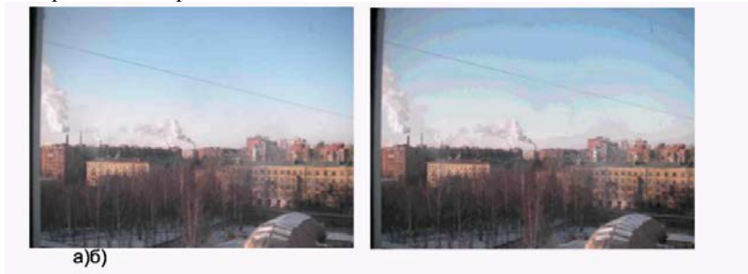
Рис. 1.20. Равномерное квантование: а) число разрядов квантования L=8 , б) число разрядов квантования L=4 .
