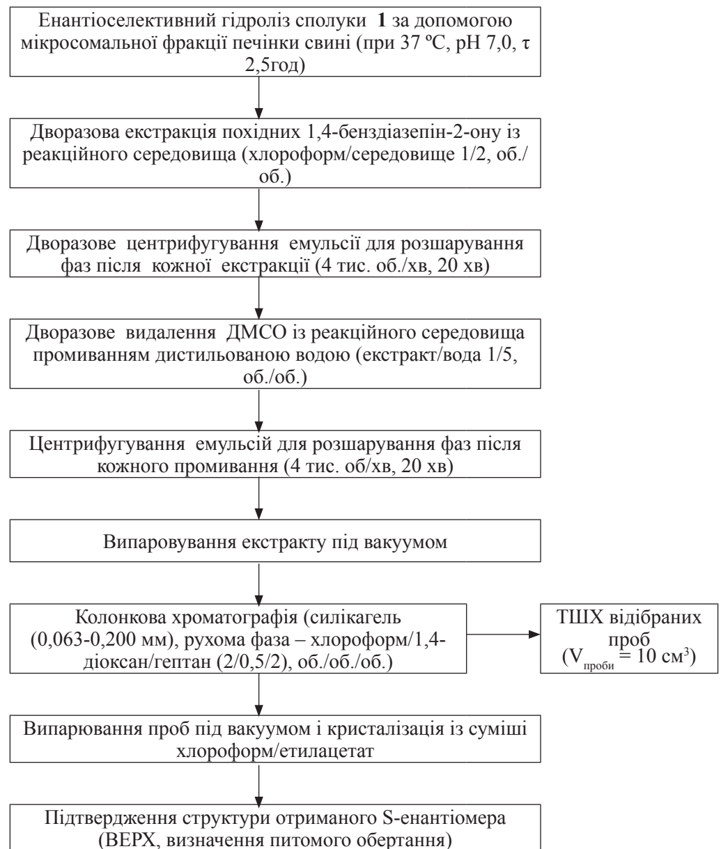
Рис. 2. Схема отримання S-енантіомера 3-ацетокси-7-бром-5-феніл-1,2-дигідро-3H-1,4-бенздіазепін-2-ону
