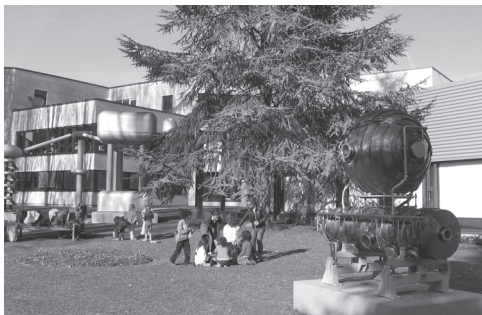
Фото 3. Предшественник ЛHC – одна из высокочастотных ускорительных полостей, использовавшаяся в LEP
