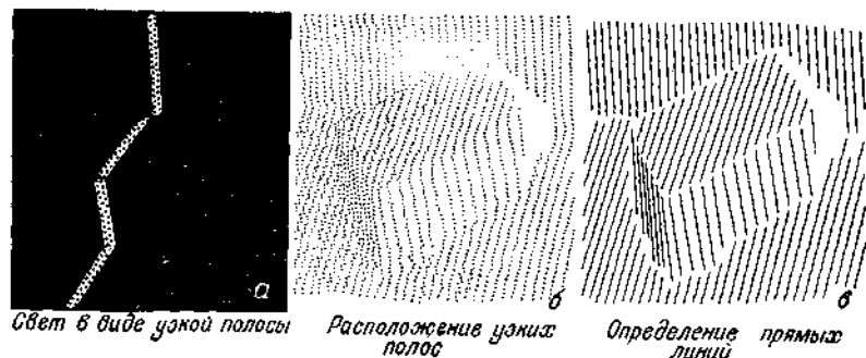
Рис. 9. Обработка информации, полученной при проецировании на предмет узких полос света а — узкая полоса света; б — конфигурация полос; в — выявление прямых линий
