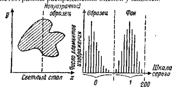
Рис. 16 Пороговая сегментация изображения.
