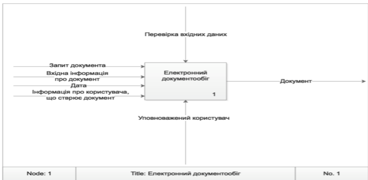
Рис. 1. Функціональна модель роботи СЕД – Контекстна діаграма IDEF0 (нульовий рівень)
