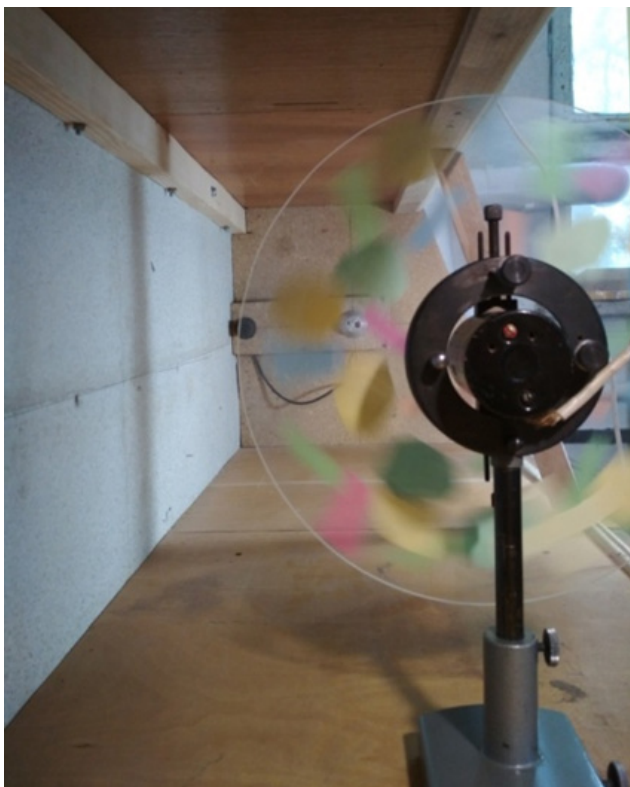
Рис. 4. Імітатор моделювання несуцільних завад
