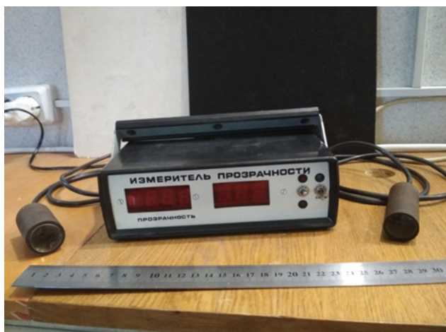
Рис. 6. Зовнішній вигляд вимірювача прозорості
