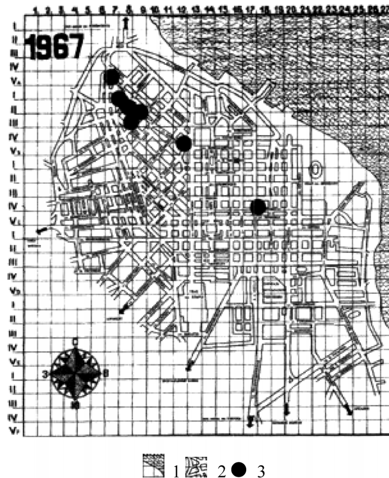
Рис. 2. Положение зданий исторического центра г. Одесса, испытавших трещинные деформации в 1967 году.
