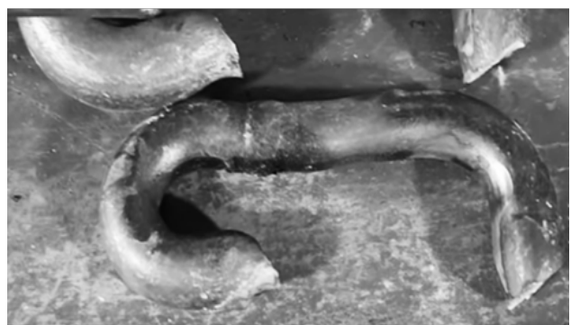
Рисунок 5. Характер деформування та руйнування ланки довголанкового вантажного ланцюга
